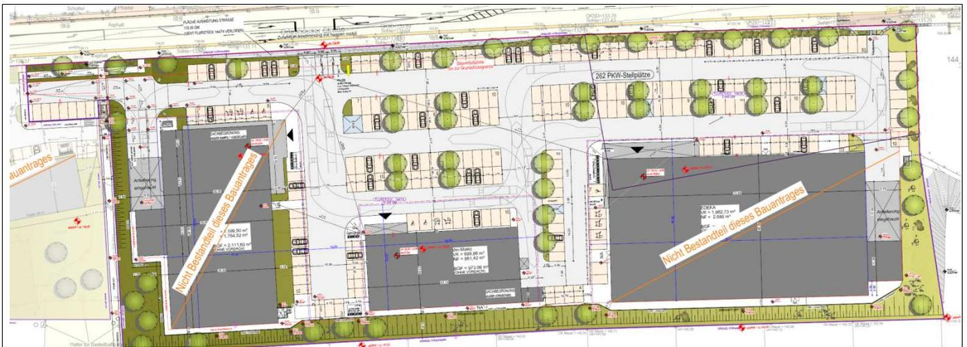
Abb. 2 : Freiflächenplan der Märkte mit möglichen Anfahrtswegen der Lkw.
